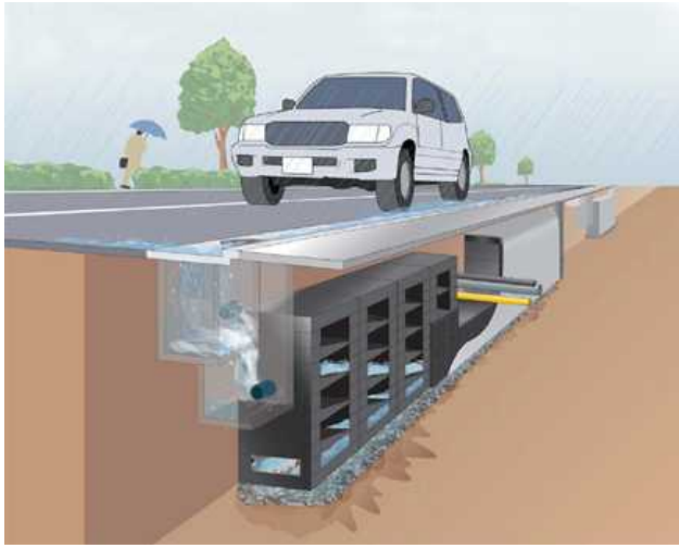
図 3-3 雨水貯留・浸透施設（プラスチック製）のイメージ
