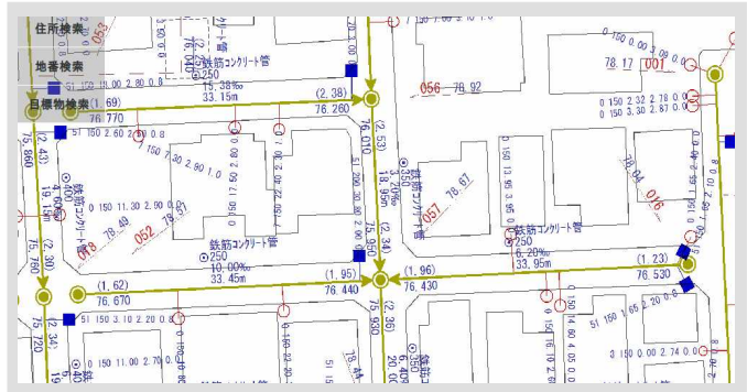
図 2-10 下水道台帳システム
